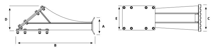
> Der am Tornado montierte Fuß ist unerlässlich als Unterstützung zum Manövrieren mit dem Raupenbagger
