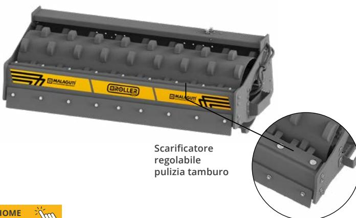
Rullo compattatore vibrante ad alte prestazioni con **tamburo con piedi di montone**, è particolarmente indicato per la compattazione di terreni coesivi, come argilla e terriccio, durante i lavori di costruzione, utilizzabile anche per il mantenimento di strade sterrate.
